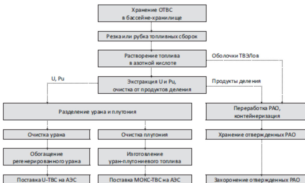
Рисунок 14 – Схема переработки ОЯТ
