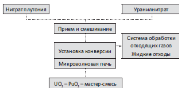
Рисунок 13 – Прямое производство МОКС-порошков из раствора нитратов урана и плутония
